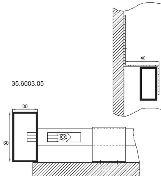
**WICHTIG:** Nicht alle Zubehör möglich wenn bei Montage die Rückwand (6 bis 19mm) vor die Säule montiert wird.
