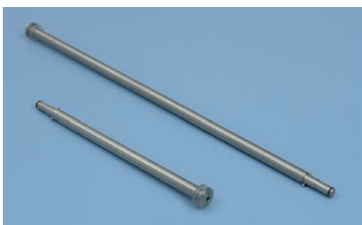
Produkt DEKOSTÄBE GLAS Umschreibung Geradestehende Dekostäbe für Glasplatten. Komplet mit Kopfschraube und Kunststoffringe. Lochmaß im Glas ist Ø 12 mm. Werkstoff Edelstahl geschliffen
